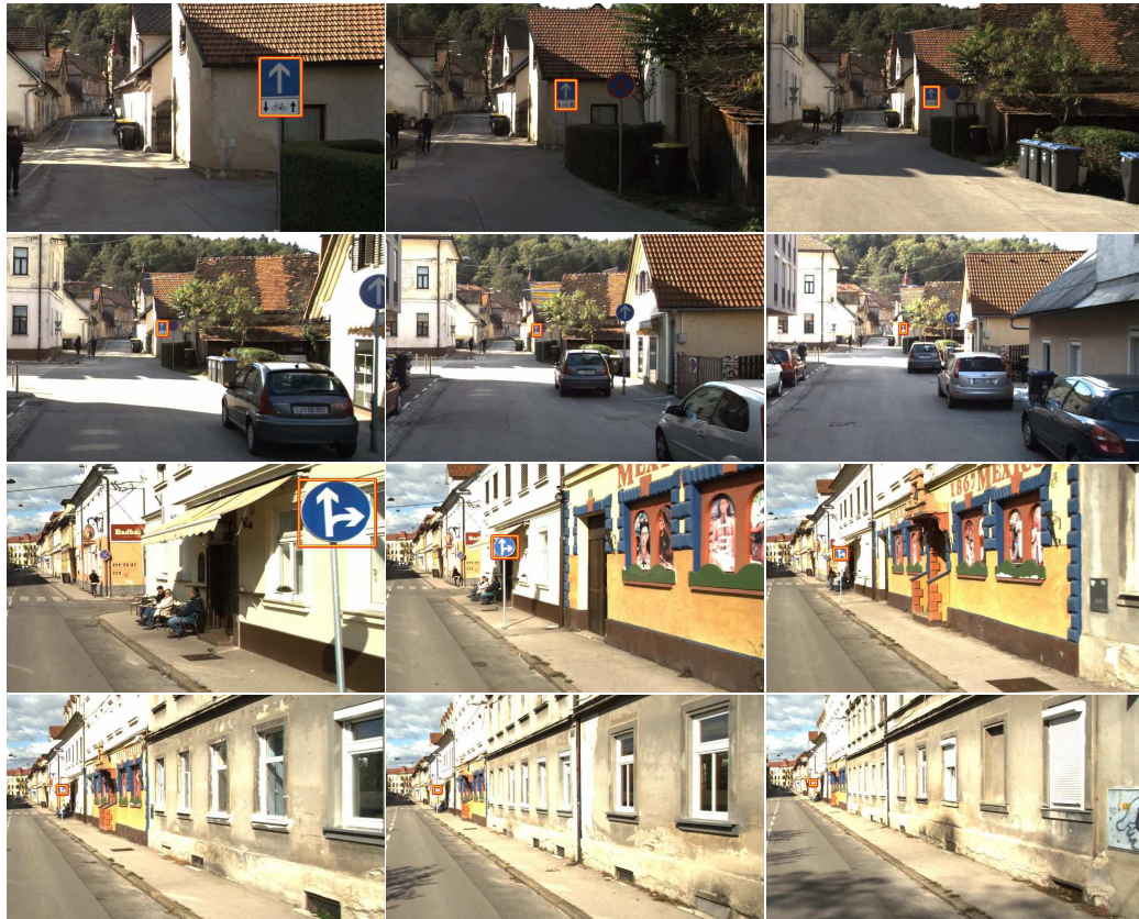
Figure 7: Primer vizualnega sledenja prometnih znakov iz kamere na avtomobilu v mobilnem kartirnem sistemu. Opaziti je mogoče, da sledilnik zelo dobro naslavlja tudi spremembo skale, saj se velikost prometnega znaka preko sekvence signifikantno zmanjšuje.
