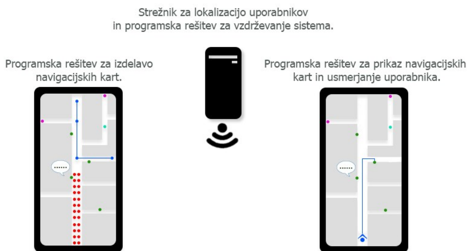
Slika 6: Tri komponente navigacijskega sistema.
