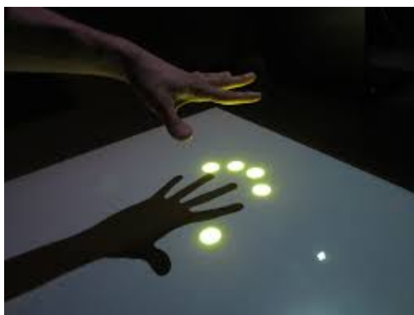
Slika 3.2: Zaznavanje prstov ob zagonu večdotične površine.
