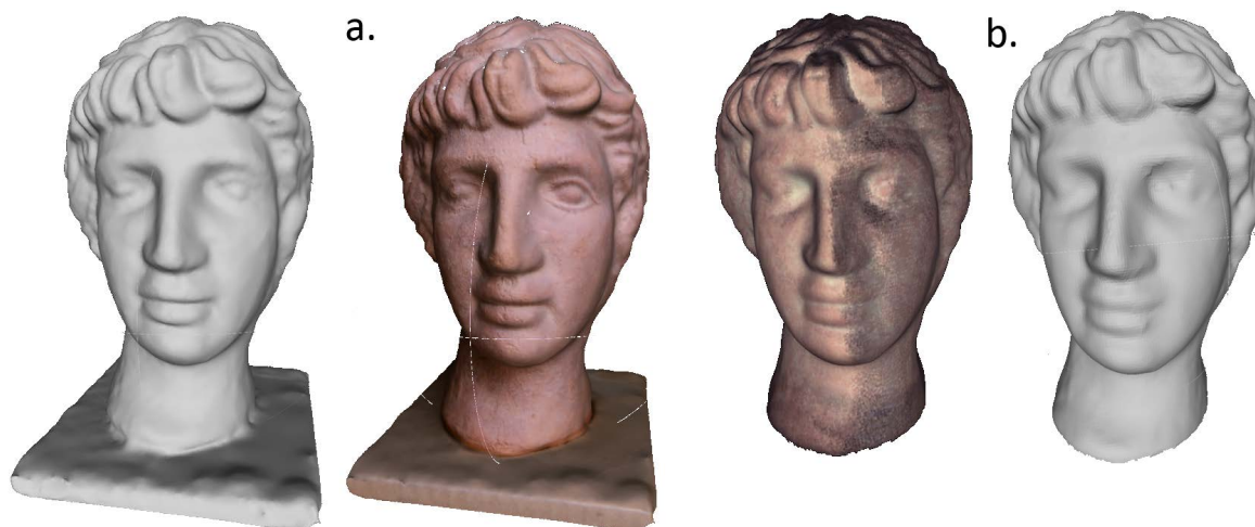
Slika 13: Kip Apolona, na katerem so bili izvedeni testi snemanja: a. 3D model narejen s fotogrametričnim procesiranjem, b. 3D model posnet s snemalnikom Artec MHT. (Foto in 3D modeli: Rok Kovačič, procesiranje z Autodesk 123D, 3D ogled z Meshlab)
