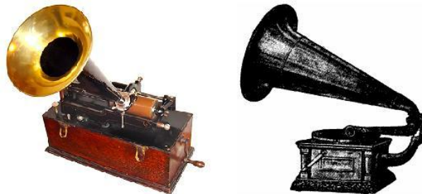
Slika 2.4: Edisonov valjni fonograf in gramofon na osnovi plošče
