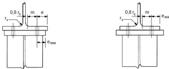
Figura 3.14 - Definição de e , e_{min} , r_c e m , fonte: (CEN, Eurocódigo 3 - Projeto de estruturas de aço - Parte 1-8: Projeto de ligações, 2005)
