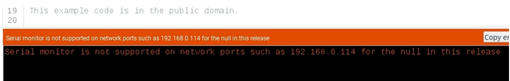
Slika 4.4: Primer neuspelega poskusa vzpostavitve serijske konzole za razvojno ploščico WEMOS D1 mini , ki ne podpira SSH .
