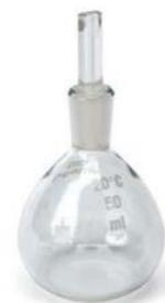
*Image d'un pycnomètre*
