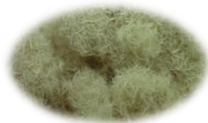
Figure III. 1. Fibres courtes de bois
