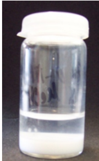
Abb. 3.1: Dispersion der ZnO(NP) in Methanol. Schon nach ein paar Stunden sedimentieren die Nanopartikel aufgrund der nicht vorhandenen Stabilisierung.
