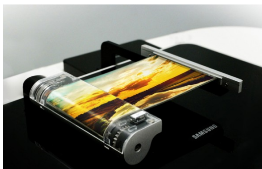
Abb. 1.1: Prototyp eines aufrollbaren Displays, vorgestellt von Samsung auf der "Display Week 2016" in San Francisco [3].
