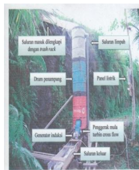
Gambar 2. Skema Instalasi Sistem Pembangkit Mikrohidro dengan Drum
