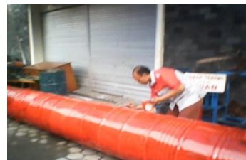
Gb.2 Pengecatan Rumah Pembangkit (Drum)
