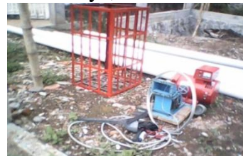
Gambar 3. Turbin cross flow dan Generator
