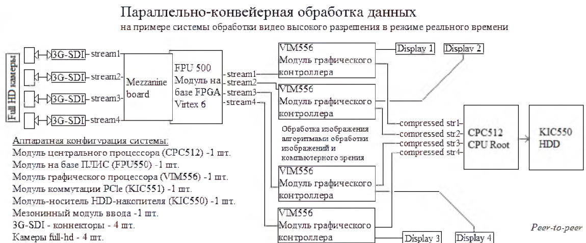
Рис. 1. Параллельно-конвейерная обработка данных на примере системы обработки видео высокого разрешения в режиме реального времени, построенной на базе ВГВП Fig. 1. The parallel-pipelined data processing system as an example of processing high definition video in real time, based on the constructed VGVP
