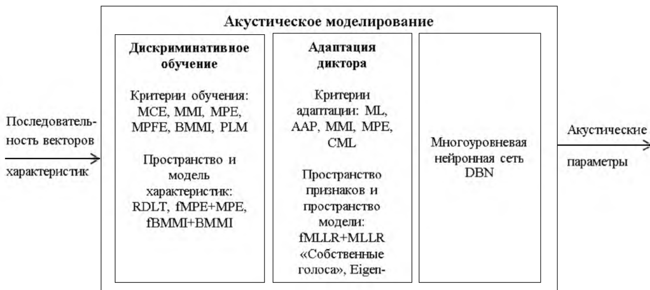
Рис. 4. Методики акустического моделирования Fig.4. Techniques of acoustic modeling
