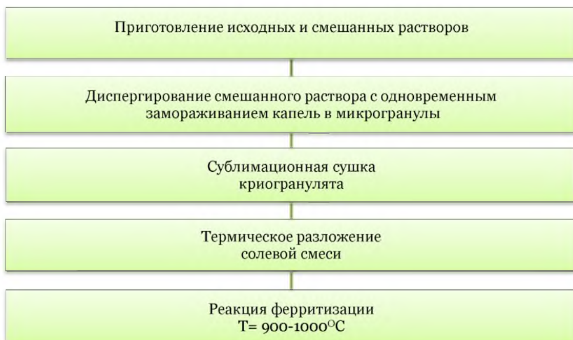
Рис. 1. Блок-схема метода получения нанодисперсных ферритовых порошков с использованием элементов криохимической технологии [1].
