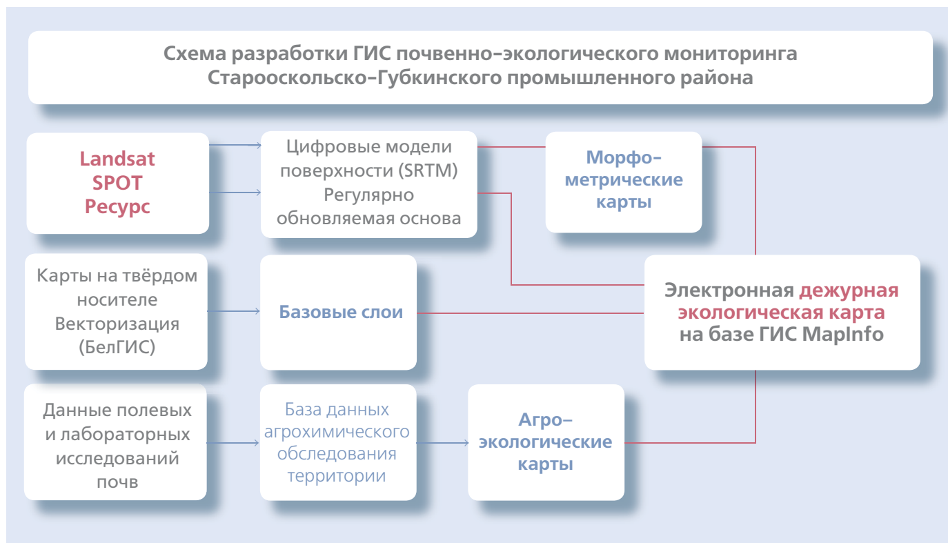
Рис. 4. Схема разработки ГИС почвенно-экологического мониторинга Старооскольско-Губкинского промышленного района
