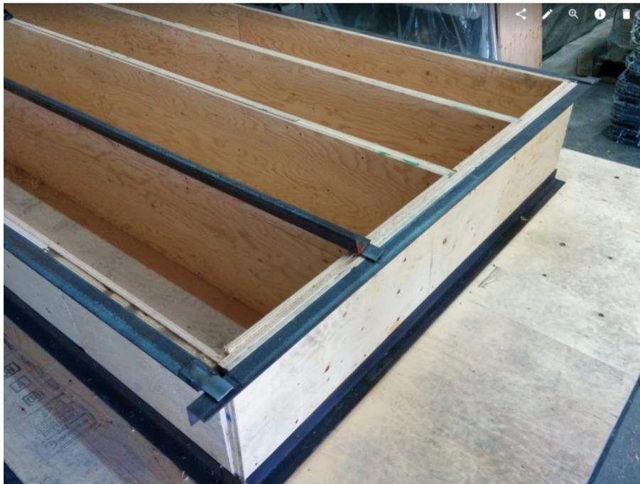
Figure 3-9 : Murets intérieurs pour avoir quatre rangées de spécimens
