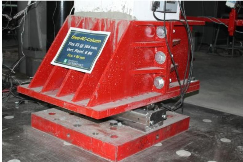
Figure 3-14 : Vue en gros plan d'un des collets en acier pour appliquer la charge excentrique
