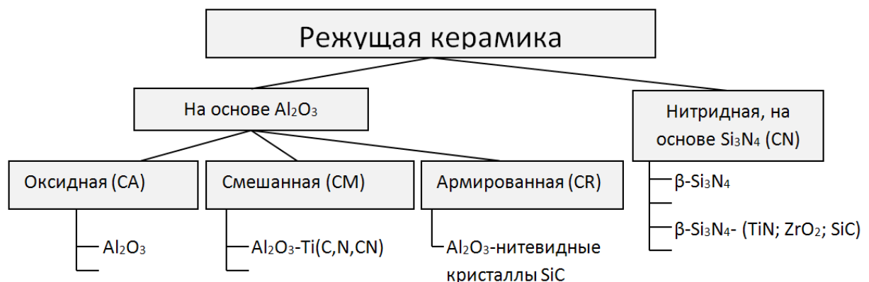
Рис.1. Основные типы режущей керамики, используемые при производстве режущих инструментов.
