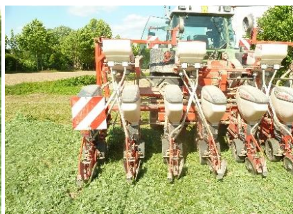
Foto 1: Roller-crimper. Foto 2: Seminatrice no-till. Foto 3: Pacciamatura dopo il passaggio della seminatrice.
