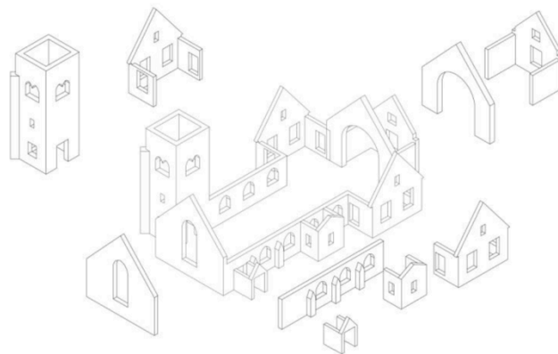
Figura 2. Scomposizione della chiesa in macroelementi.
