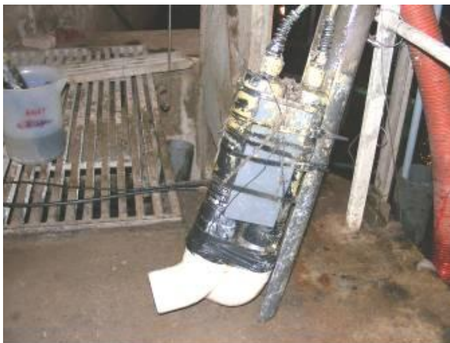
Figure 4 - Les turbidimètres avec leur protection individuelle Figure 4 - Turbidimeters with their individual protection
