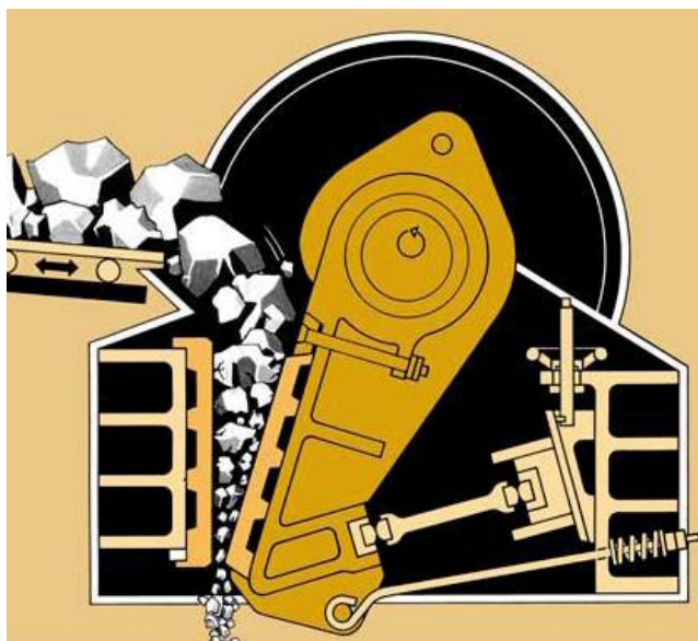
Figura 15 - Britador de mandíbulas de um eixo Fonte: Metso (2005)
