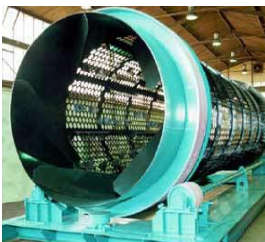
Figura 20 - Representação esquemática de um Trommel Fonte: Metso (2005)
