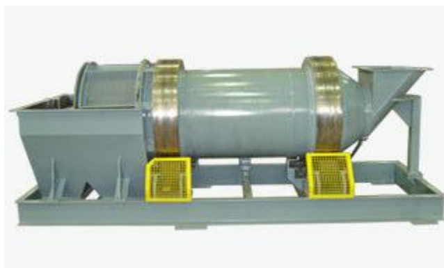
Figura 22 - Tambor rotativo Fonte: Metso (2005)
