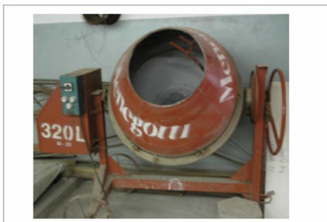
Figura 3.13 – Betoneira de eixo inclinado com capacidade de 320 litros
