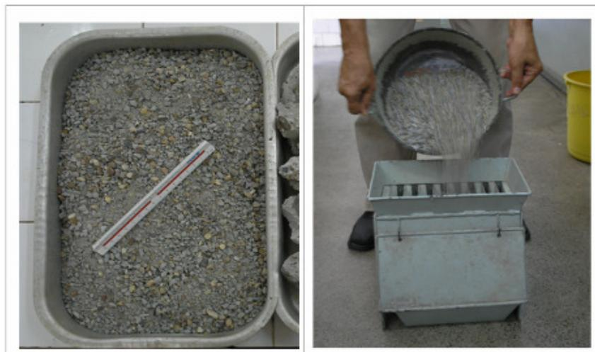
Figura 3.11 - Agregado de ACR selecionado seco e quartejamento para análise granulométrica.
