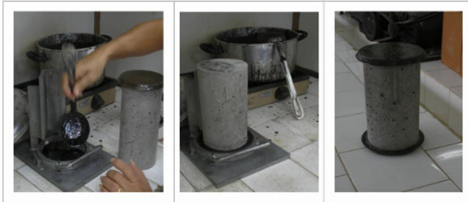
Figura 3.17 - Capeamento de CP para rompimento
