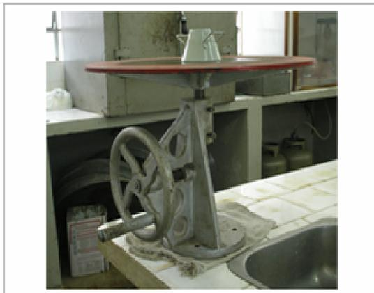
Figura 3.14 - Mesa para teste de consistência
