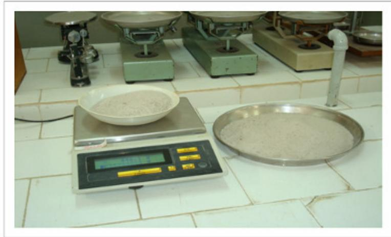
Figura 3.6 - Balança digital com precisão de 0,1 g
