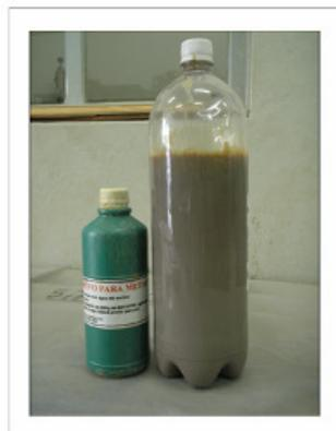
Figura 3.4 - Espumante termopolímero acrílico
