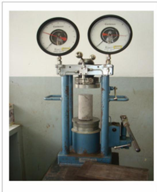
Figura 3.18 - Prensa hidráulica para ensaio manual de resistência mecânica à compressão
