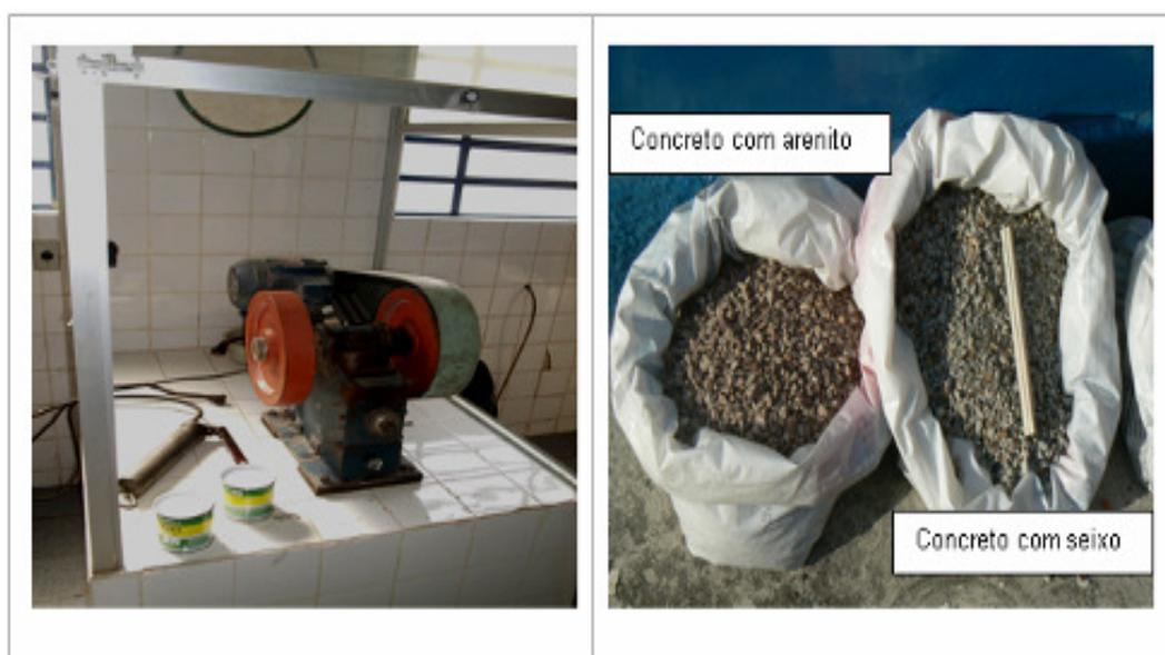
Figura 3.10 - Britador utilizado e material triturado de concreto produzido com arenito e concreto produzido com seixo.
