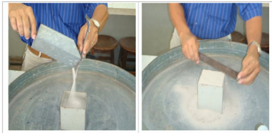
Figura 3.9 - A deposição do agregado no frasco e seu rasamento.
