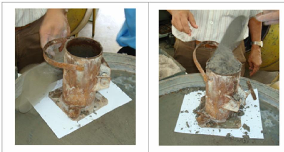
Figura 3.15 - (A) Limpeza e preparo; (B) Moldagem do CP.
