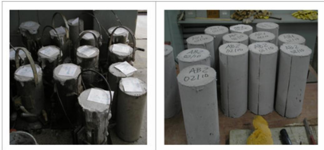
Figura 3.16 – (A) CP moldados em descanso; (B) CP desmoldado e identificado.
