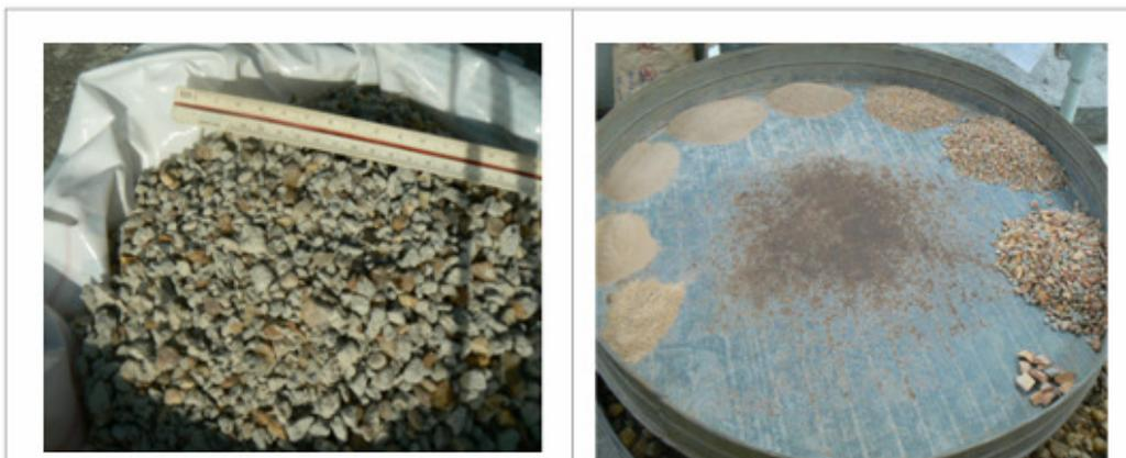
Figura 4.2 - Agregado de ACR triturado e e separado por peneira.
