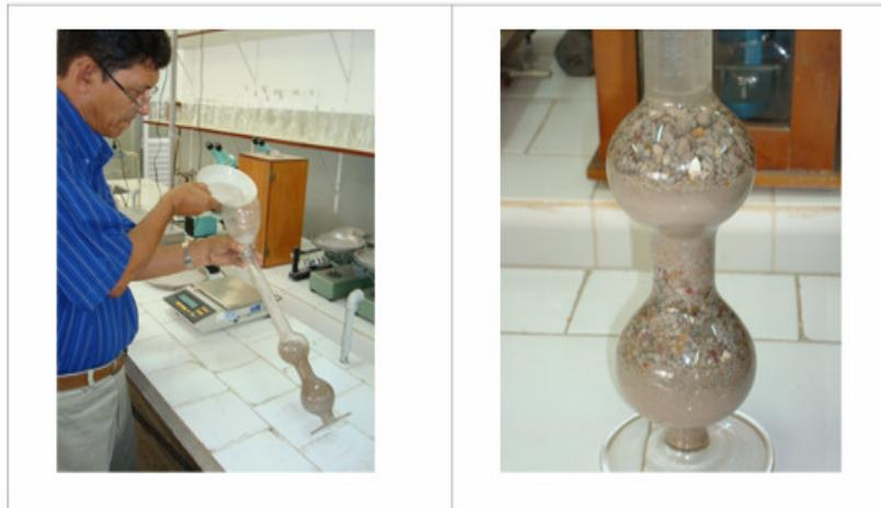
Figura 3.8 - Ensaio da massa específica no frasco de CHAPMAN
