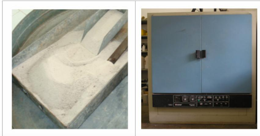
Figura 3.5 - (A) Areia seca em bandeja; (B) Estufa de secagem e esterilização.
