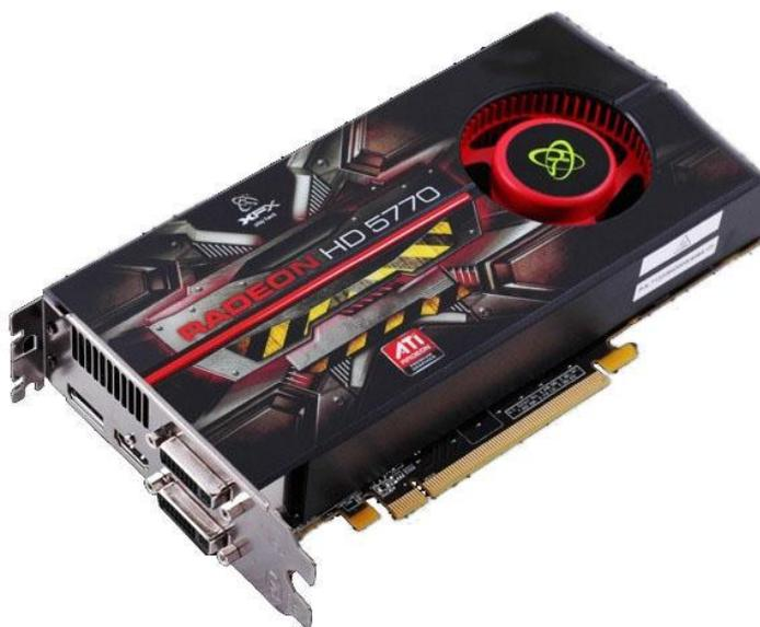
**Figura 5 – GPU típica de computadores desktop.**
