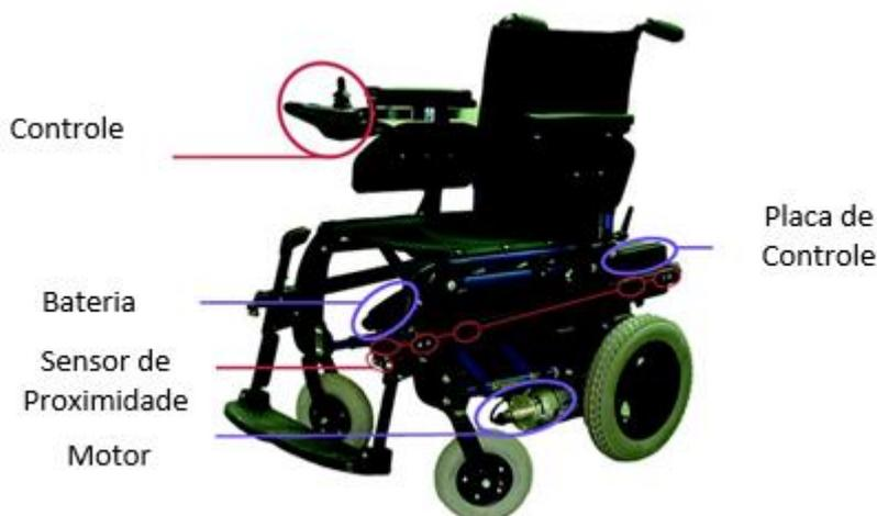
**Figura 13 – Componentes básicos do Intellwheel.**
