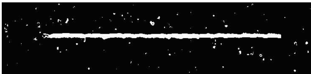
Figura 5.25 – Falta de Penetração Segmentada.
