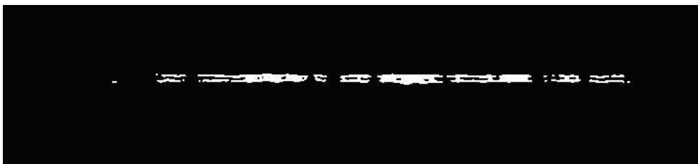
Figura 5.19 – Falta de Penetração Segmentada.
