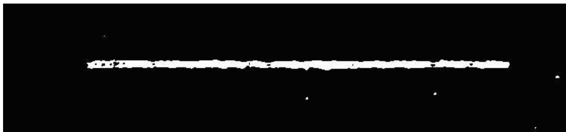
Figura 5.12 – Falta de Penetração Segmentada.
