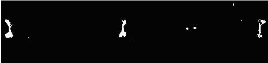
Figura 5.13 – Inclusão de Escória Segmentada.
