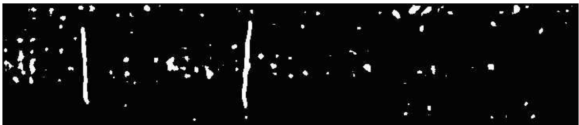
Figura 5.10 – a) Solda com Trinca Transversal (Manual da AGFA), b) Defeito Segmentado.
