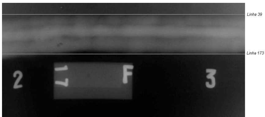
Figura 5.29 – Cordão de Solda Segmentado ( K = 15 ).
