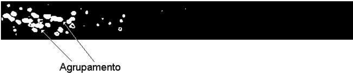
Figura 5.42 – a) Segmentação do Cordão, b) Segmentação dos Defeitos (Porosidade Agrupada).
