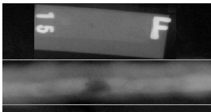
Figura 5.36 – Cordão de Solda Segmentado (imagem teste 4).
