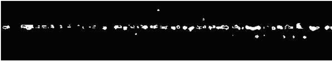
Figura 5.21 – Porosidade Alinhada Segmentada.
