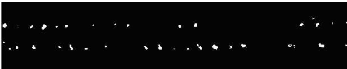
Figura 5.15 – Falta de Fusão Segmentada.
