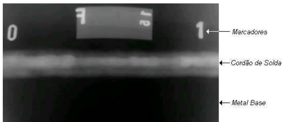
Figura 4.17 – Imagem radiográfica de uma junta soldada com marcações.
