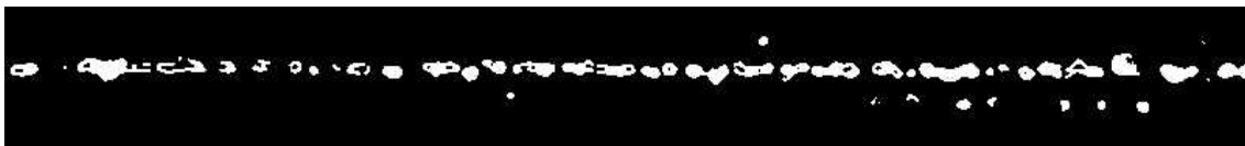
Figura 5.37 – a) Segmentação do Cordão, b) Segmentação dos Defeitos (Porosidade).
