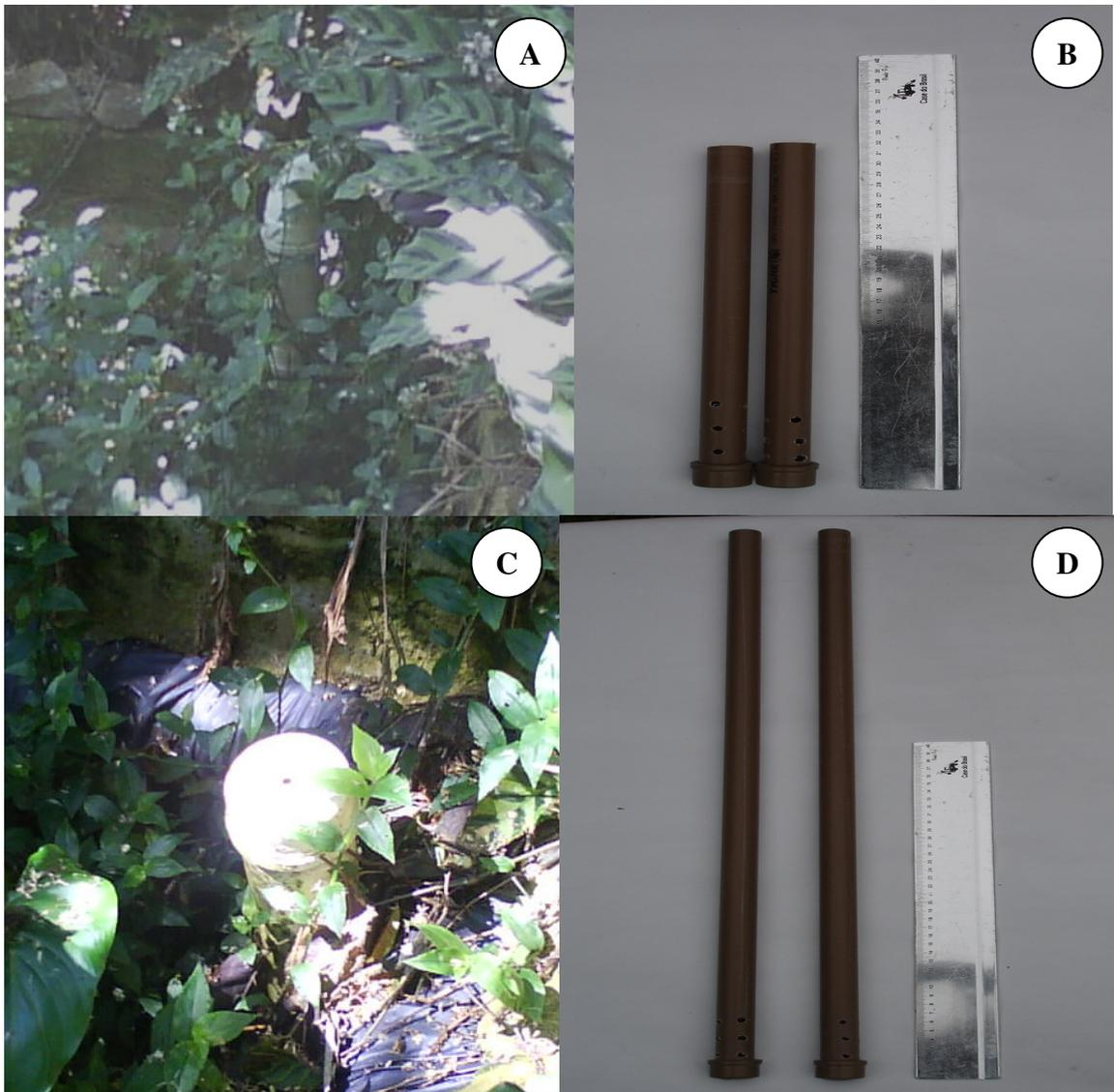
**Figura 5: Tubos para coleta: A) entrada do esgoto bruto na estação; B) tubos com 30 cm de comprimento para coleta de amostra na interface zona de raízes-brita; C) tubo de 70 cm de comprimento para coleta de amostras no filtro de areia; D) respiro para coleta do efluente tratado**
