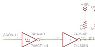
Figura 127 - Circuito de acionamento do driver
