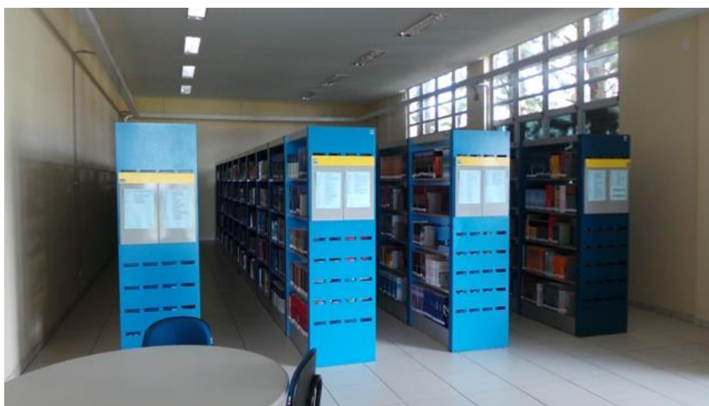
Figura 45 – Fotografia – Fileira de luminárias perto das janelas com comando separado Fonte: Autoria própria
