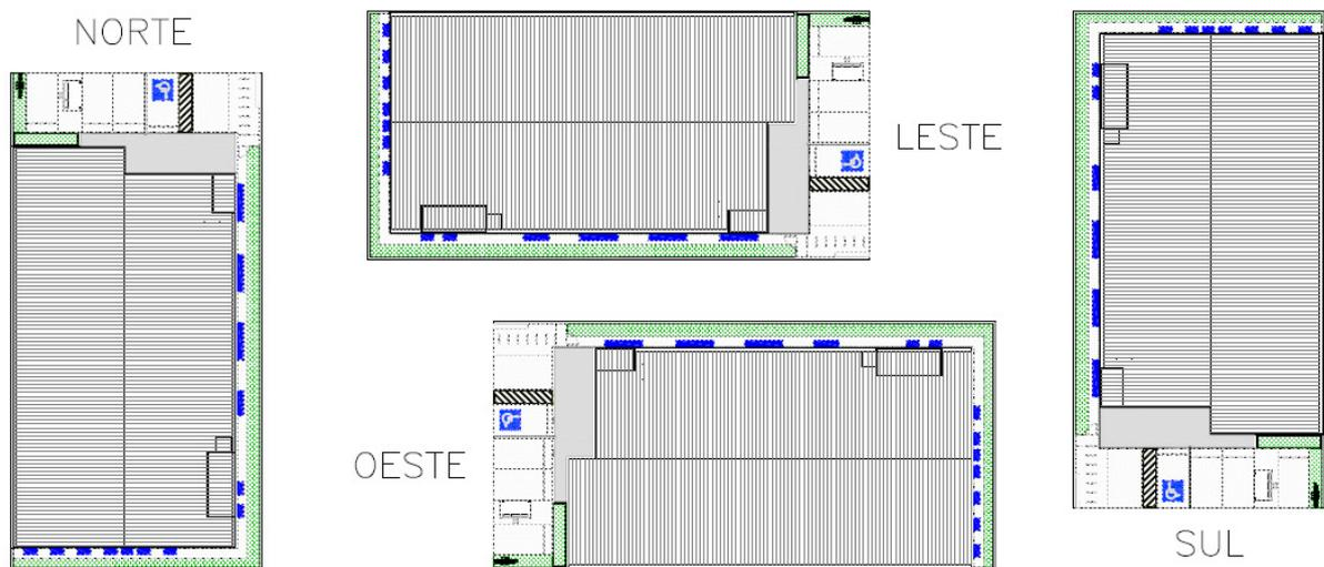
**FIGURA 10 – IMPLANTAÇÃO DO PROJETO PADRÃO DE ACORDO COM A ORIENTAÇÃO SOLAR DA ELEVAÇÃO FRONTAL**
