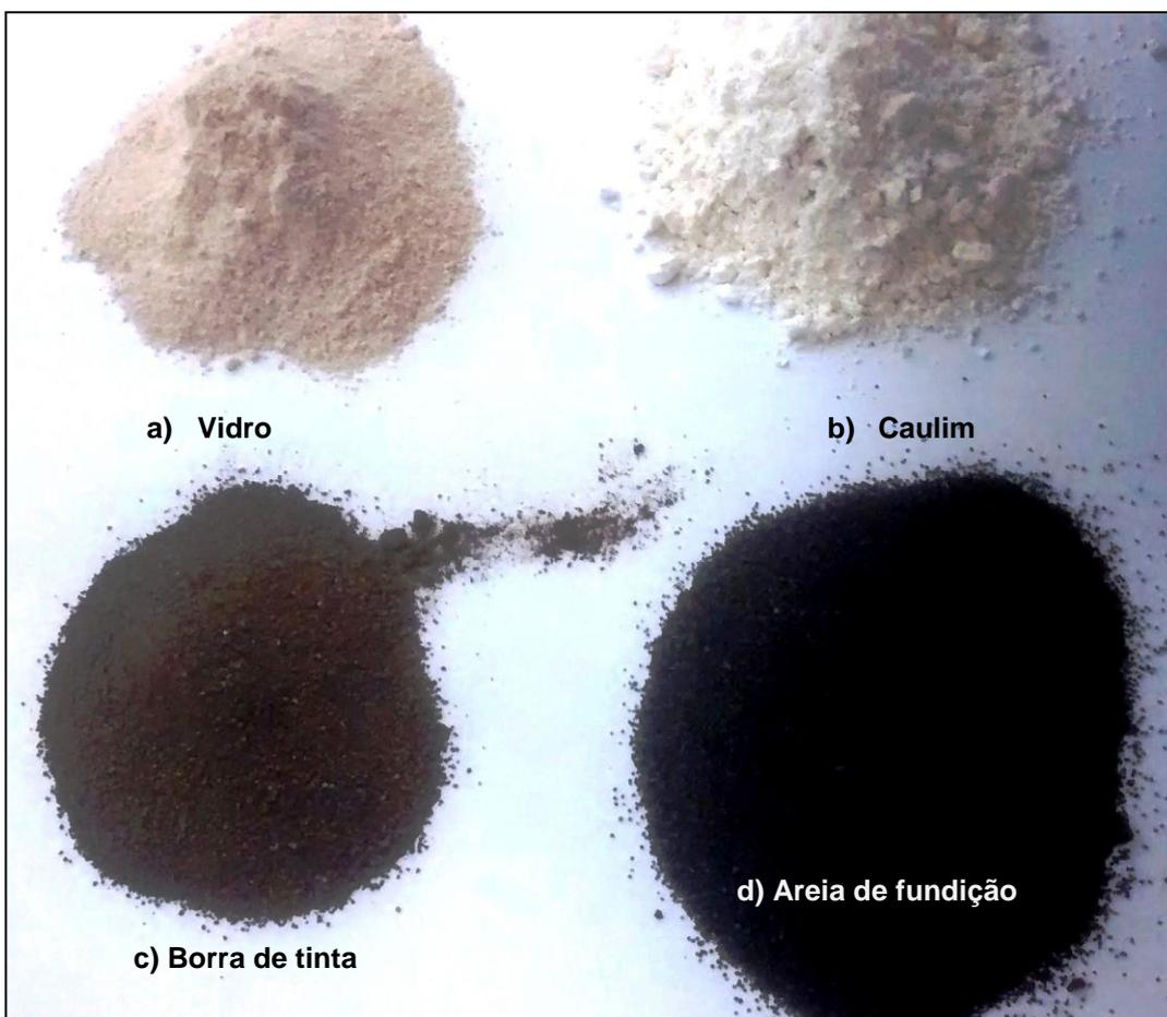
Figura 1 - Matérias-primas para execução dos corpos de provas
