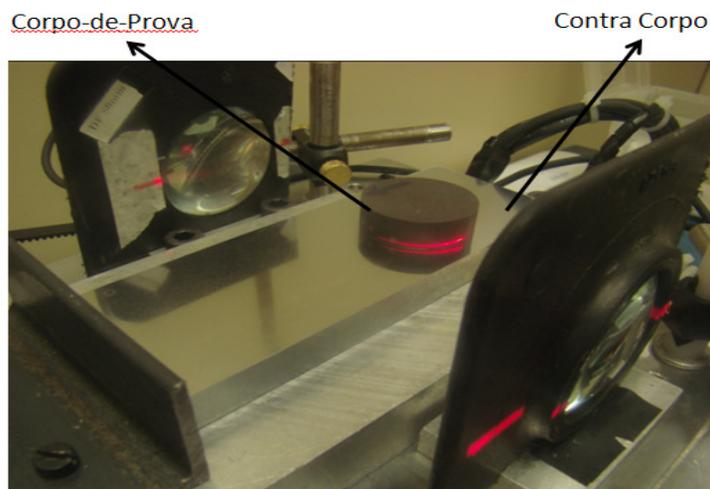
Figura 3-4 Corpo de prova e contra-corpo ensaiados
