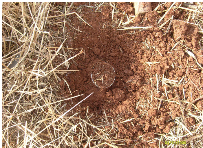
Figura 7 – Coleta de solo em anel volumétrico para realização das avaliações físicas de solo. Coronel Vivida – PR, 2011.
