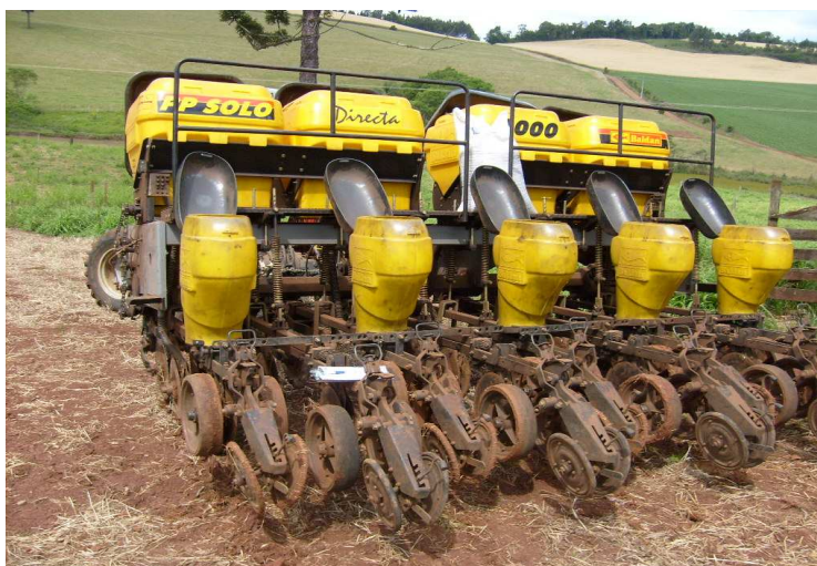
Figura 4 – Semeadora-adubadora utilizada no experimento. Coronel Vivida – PR, 2011.
