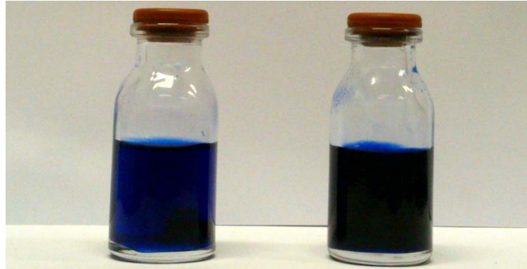
Figura 14 - Retenção do corante BB 41 (concentração inicial de 500 \text{ mg.L}^{-1} ) pela matriz RA + NaOH + AMCA após o ensaio em batelada NOTA: À esquerda frasco contendo solução de corante mais a amostra de RA + NaOH + AMCA e à direita solução de corante na concentração de 500 \text{ mg.L}^{-1} .
