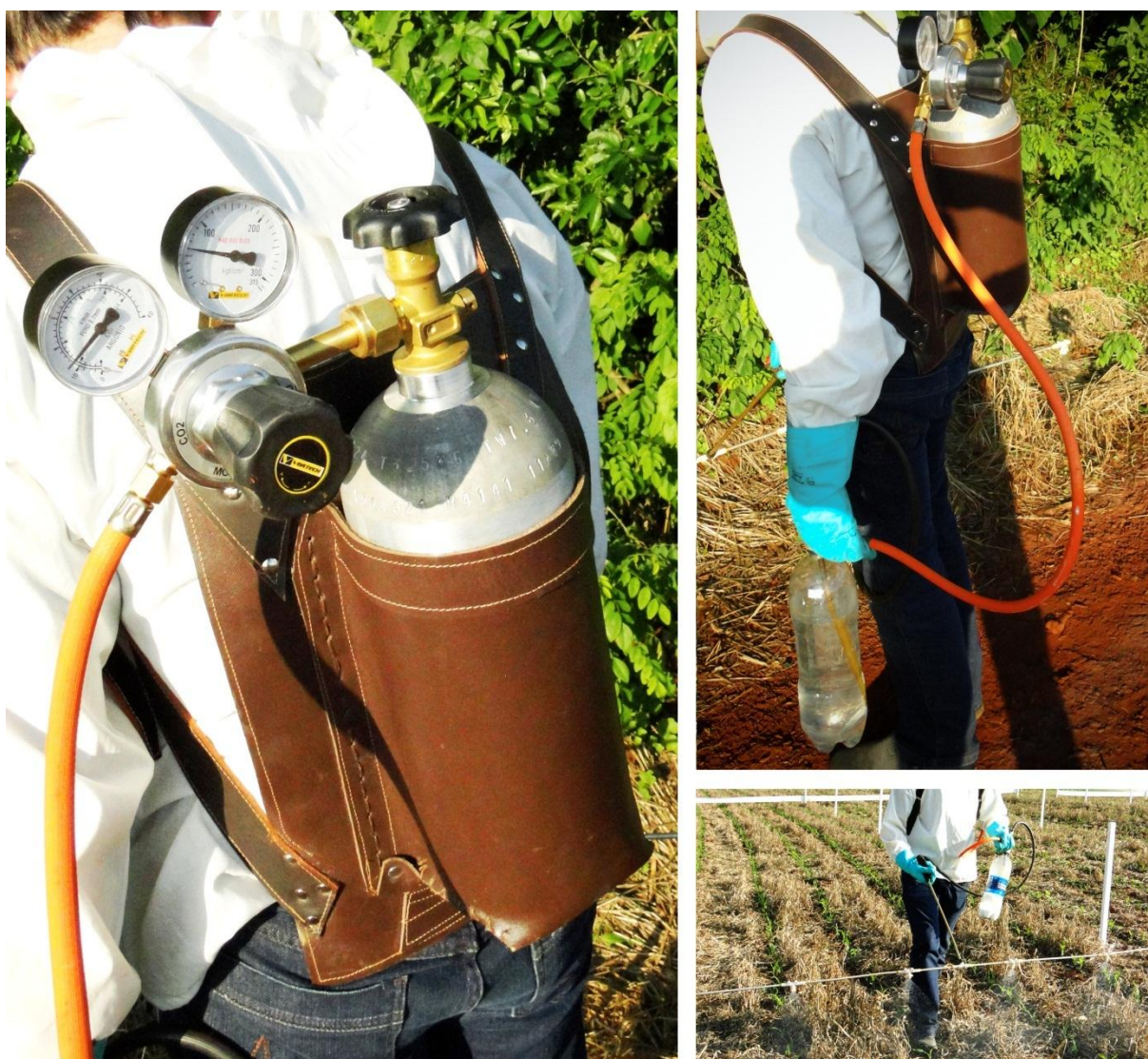
Figura 10 – Esquerda: Detalhe do cilindro de gás - Pulverizador costal de CO 2 pressurizado. Direita Inferior: Aplicação dos herbicidas, sistema consorciado de milho e papuã. Direita-superior: Lavagem do sistema do pulverizador com água pura, entre a aplicação dos tratamentos de herbicida. (Fotos: J.R. Oliveira)
