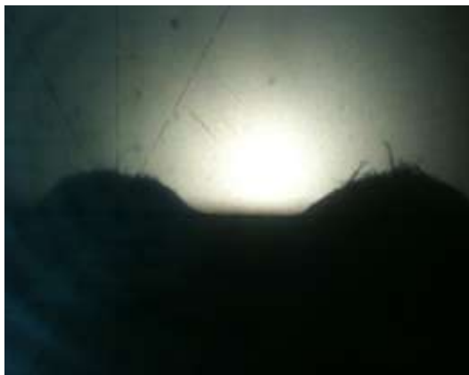
Figura 27 – Foto de 2 pontos Braille de igual perfil, forma e altura de 364 \mu\text{m} impressos por impacto
