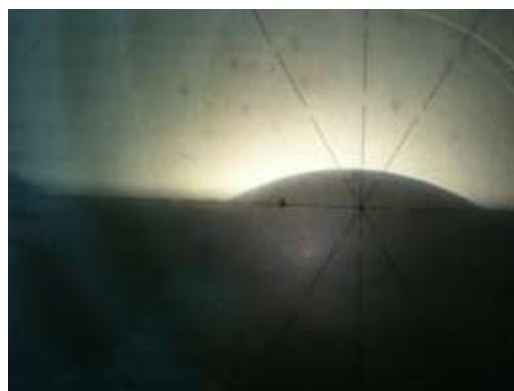
Figura 28 – Primeira Foto do perfil sinusoidal ponto Braille impresso sobre substrato laminado.
