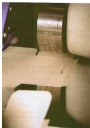
Figura 25 - Foto do processo de impressão por deformação mecânica do fabricante BOBST embossing mediante relevo rotatório.
