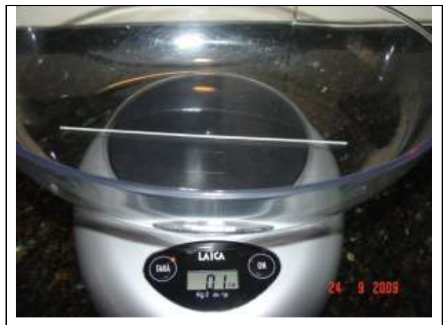
Figura 22 – Esquerda: Leitor Braille deficiente visual aplica pressão ao material. Direita: Balança eletrônica que foi usada para o leitor fazer a sua leitura tátil.
