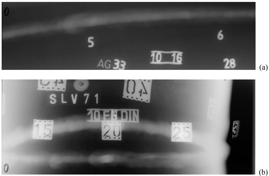
Figura 5.3 – (a) Radiografia panorâmica de um cordão de solda com reforço (imagem de 1298 × 4880 pixels da coleção BAM-I); (b) Radiografia PD-VD de um cordão de solda incompleto (imagem de 1760 × 4668 pixels da coleção BAM-I).
