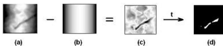
Figura 4.12 – Sequência de resultados obtidos por Wang e Liao (2002), através da subtração da imagem original (a) com o fundo estimado (b) antes (c) e após (d) a limiarização.
