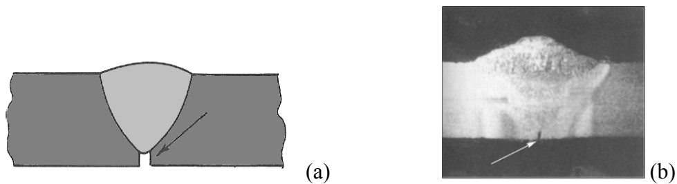
Figura 2.6 – (a) Esquema de secção transversal de junta soldada com FP; (b) Fotografia da secção transversal de uma junta soldada com FP (AWS, 2001);
