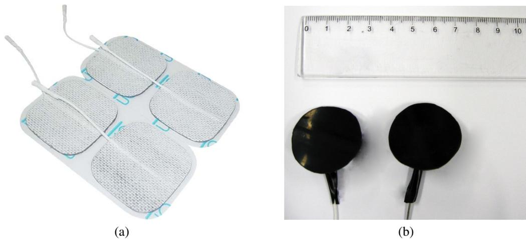
**Figura 21: Eletrodos utilizados para verificar a possibilidade de serem utilizados nos exames de RM. (a) Eletrodo adesivo comercial ( $25\text{ cm}^2$ ), marca Valutrode. (b) Eletrodo circular de silicone fabricado manualmente ( $\cong 9\text{ cm}^2$ ).**
