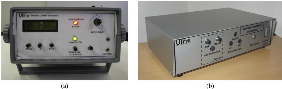
**Figura 19: Primeira (a) e segunda (b) versão do estimulador galvânico vestibular. (a) A primeira versão do EGV (junho de 2008) foi construída em um bastidor de plástico. (b) A segunda versão (abril de 2009) foi construída em uma caixa de alumínio com espessura de 1,2 mm, a qual promoveu o isolamento magnético dos sinais provenientes do escâner de RM.**
