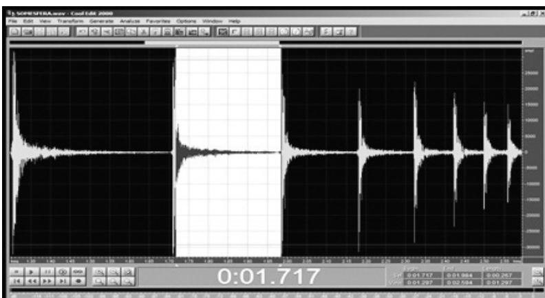
Ilustração 11 – Medição do intervalo de tempo \Delta t_{n+1} . Dados do Grupo 1 Fonte: Autoria própria (2011).
