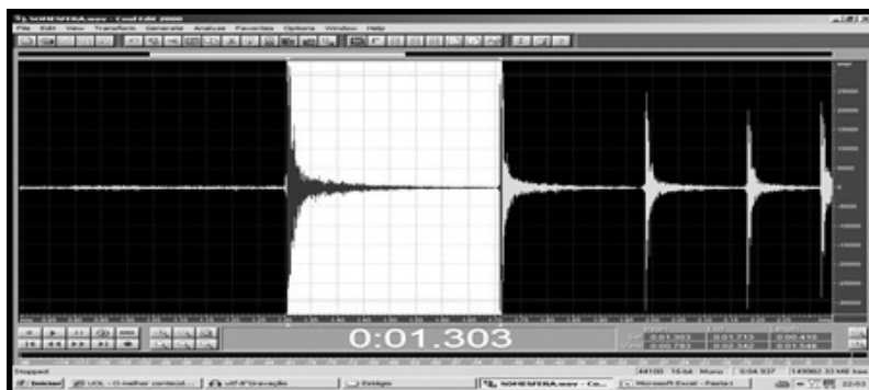
Ilustração 10 – Medição do intervalo de tempo \Delta t_n . Dados do Grupo 1 Fonte: Autoria própria (2011).
