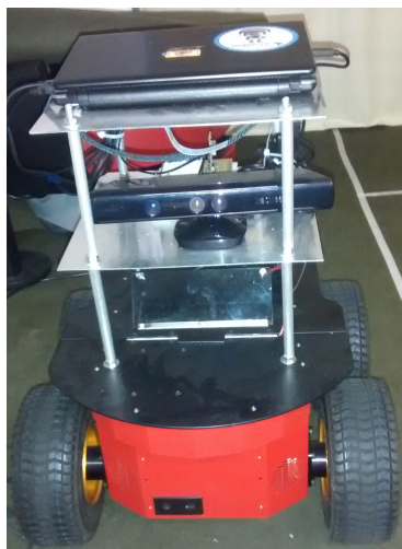
Figura 4.2: Visão frontal do Robô Pioneer 3-AT com o sensor Kinect e netbook.
