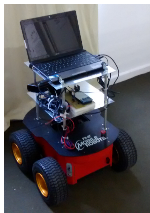
Figura 4.1: Robô Pioneer 3-AT com as modificações realizadas para a execução do projeto.
