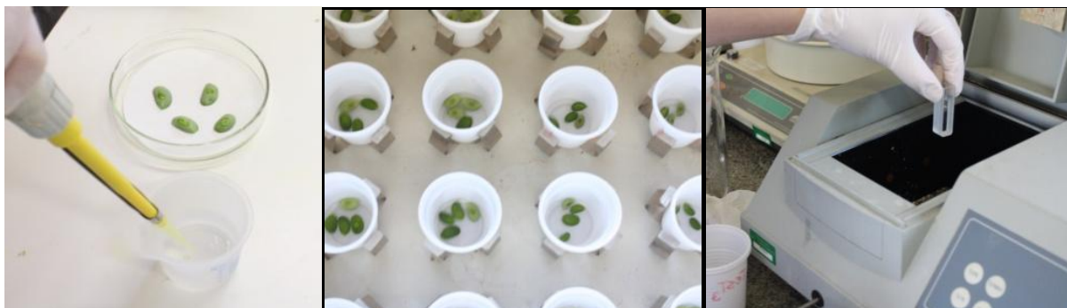
Figura 5.2. A) Aplicação do produto sobre cotilédones de soja em placa de Petri®. B) Agitação magnética - extração de gliceolina; C) Leitura sendo realizada em espectrofotômetro UTFPR, Dois Vizinhos - PR, 2012.
