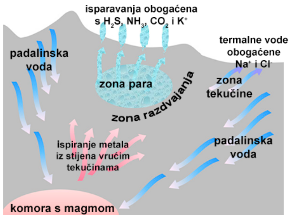
Slika 8. Kopneni geotermalni sustav, poprečni presjek (preuzeto i prilagođeno iz Mulkidjanian et al., 2012.)
