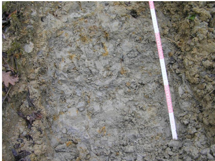
Slika 4.2. Masivni sivi glinoviti silt facijesa F1 sa stupa Subocka.
