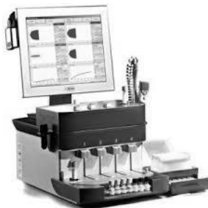
Slika 8. ROTEM tromboelastometrijski uređaj za mjerenje viskoelastičnih svojstava krvnog ugruška (ustupljeno ljubaznošću tvrtke Tem International GmbH, Njemačka).
