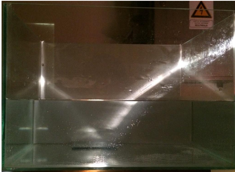
Slika 2.9: Lom svjetlosti pri prijelazu iz vode u zrak
