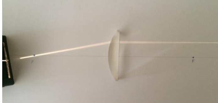
Slika 2.19: Zraka koja prolazi fokusom leće lomi se tako da je paralelna optičkoj osi
