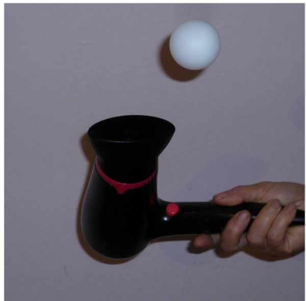
Slika 4.1.b Gibanje loptice na suženom nastavku
