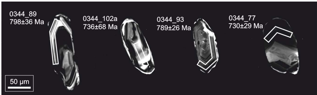
Slika 4.21. CL snimke cirkona prve podgrupe iz pete grupe (5.1.) (uzorak ST-6), s naznačenim trasama mjerenja i pripadajućim starostima. Promjer zrake mjerenja je 10-15 μm, na slici je ucrtano približno.
