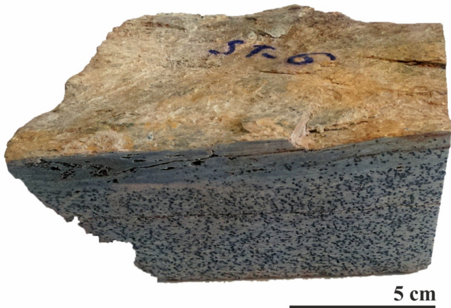
Slika 4.1. Makroskopska fotografija kloritoidnog škriljavca (Uzorak ST-6) (Tamna zrna u presjeku su minerali kloritoida).
