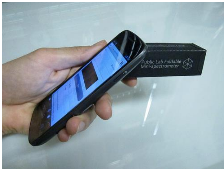
Slika 39: Tipičan pametni telefon s dodanim spektrometrom kućne izrade, preuzeto sa [32]
