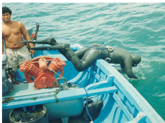
Foto 03-07 - Buceo con compresora
