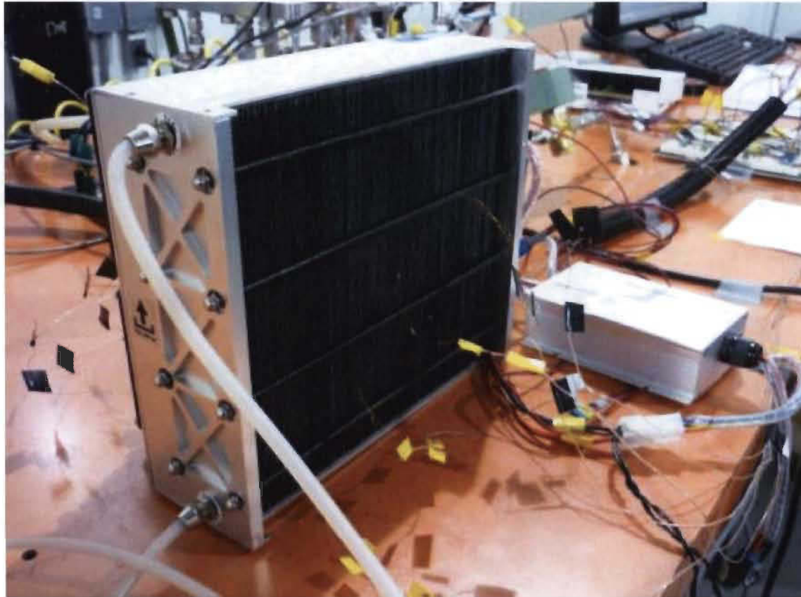
Figure A-12 Système de pile hydrogène PEM de type atmosphérique Horizon série H-1000 : vue du banc d'essai
