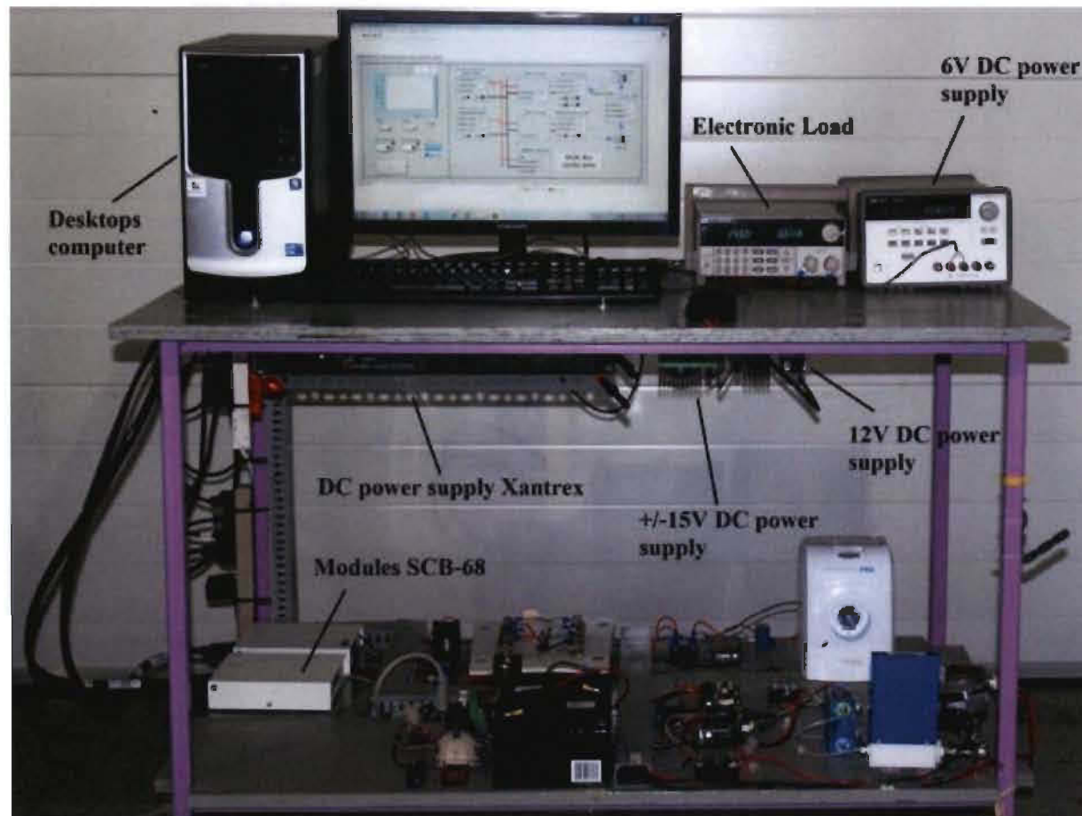
Figure A-2 Banc d'essai du système hybride à source d'énergie renouvelable : vue du dessus
