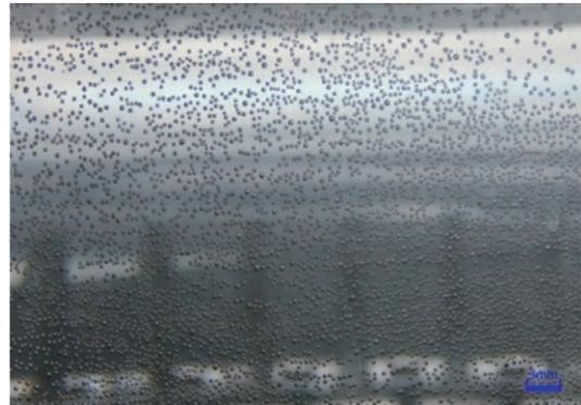
图4 微米孔板生成微气泡结构
