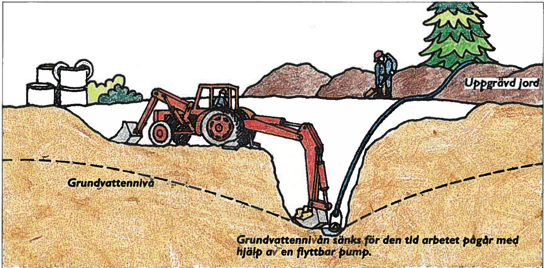
Bild 9. Grävandet av gropen.
