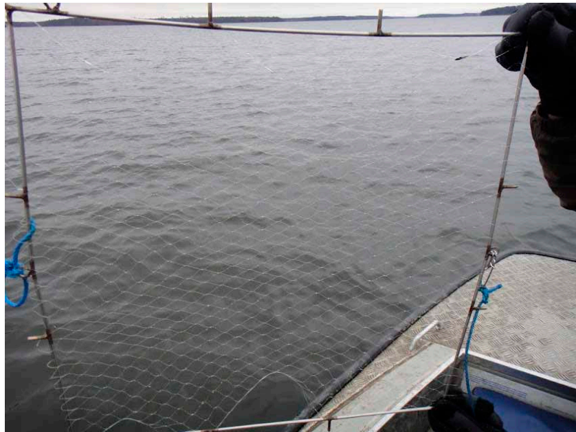
Kuva 3. Koehavas, joka on viritetty 50 x 50 cm suuruisen kehikkoon. Kuva: Pekka Westerling, Kokemäenjoen vesistön vesiensuojeluyhdistys ry.
